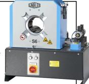
La presse S6 Ecoline développe une force de sertissage de 2000 kN/200 t et a une capacité de sertissage maximale de 100 mm. Elle est conçue pour sertir des tuyaux flexibles hydraulijusqu'à 2" ainsi que des tuyaux flexibles industriels jusqu'à
