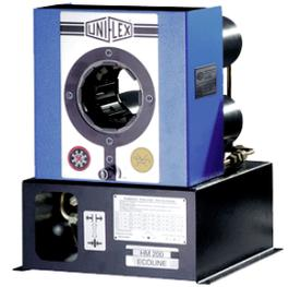
Cette presse d'atelier, en version ecoline 12 V, convient à la fois pour une utilisation fixe ou embarquée. D'une force de sertissage de 1.300 kN / 130 t et d'une capacité de sertissage atteignant 70 mm, elle peut sertir des tuyaux flexibles hydrauliques jusqu'à 1"1/4 ainsi que des tuyaux flexibles industriels jusqu'à 2".
